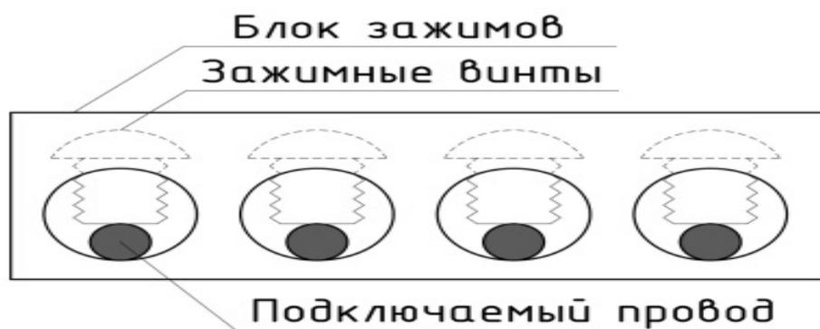
Рис. 2. Правильное подключение проводов
